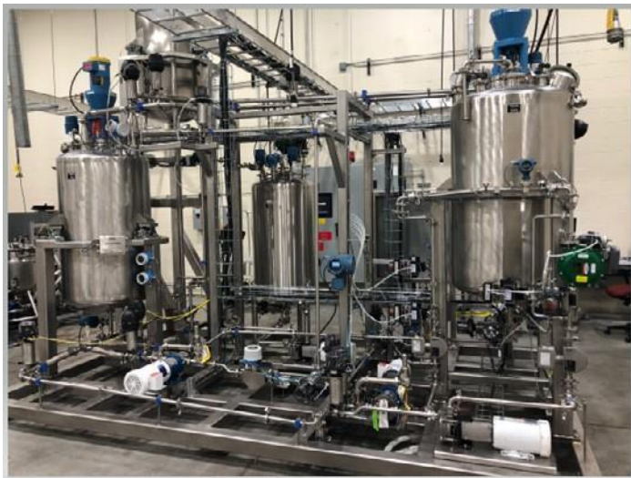
図 1: オハイオ州ウェストチェスターにある同社のコーポレート エンジニアリング テクノロジー ラボ (CETL) におけるP&GのEthernet-APLデモンストレーションプロジェクト。これには、375~500kgのタンクが4つ、流量計付きのポンプが6つ、連続処理とバッチ処理を実行する3つのユニットが含まれます。プロセス流体として水を流し、完全に自己完結型で遠隔操作がなされています。
